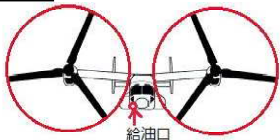
オスプレイのプロペラと給油口の位置関係 (Jetijonesによる図を改変)
